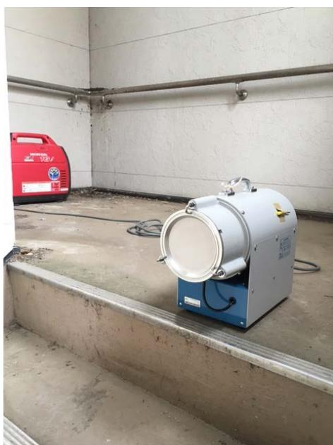
図 2 ハイボリュームエアサンプラによる大気中の放射性エアロゾルの採取
