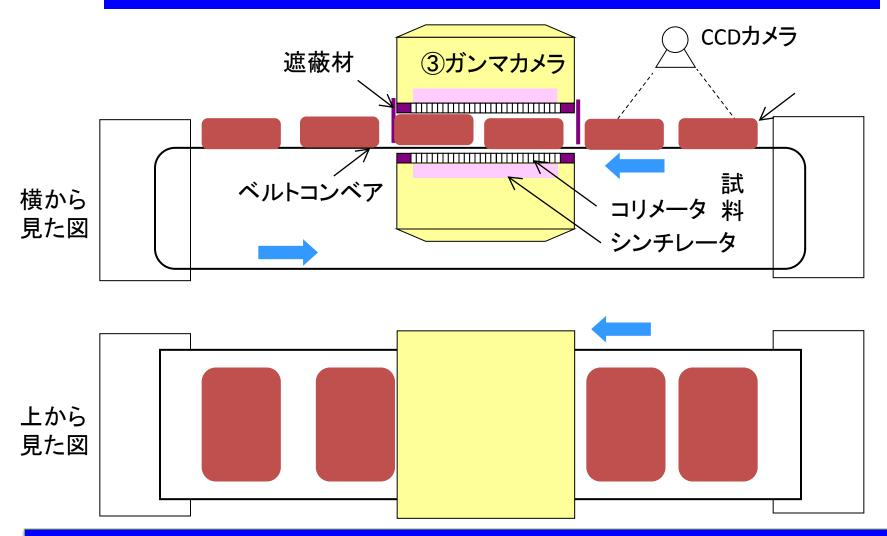
30kg米袋を10秒でみるGBO 検知器システム (20ベクレル/kgまでわかる) 現状ではまず、GBO検知器2本5列を上下で20本装備の100ベクレル/kg 迅速検出器を早期に提供。その後、GBO増強した40ベクレル/kg迅速検出を目指す。
