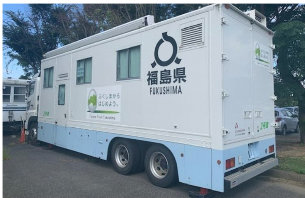
内部被ばく検査を行う ホールボディ・カウンタ搭載車両
