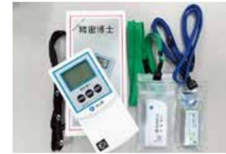
震災後、空間線量を測定する「精密博士」や、外部被ばく線量を測定する「バッジ式線量計」、1時間ごとに被ばく線量分かる「Dシャトル」を貸し出しました。
