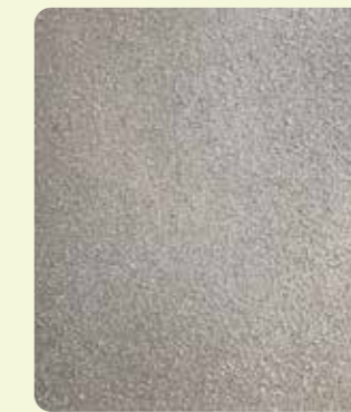
■ 塗布式薄層舗装 瓦の廃材などを骨材として、アスファルトやコンクリート舗装の上に吹き付けるタイプの舗装材。施工が容易で、路面の滑り止め効果が得られます。左の写真は、大堀相馬焼の破片を骨材としたサンプル。(全面吹き)
