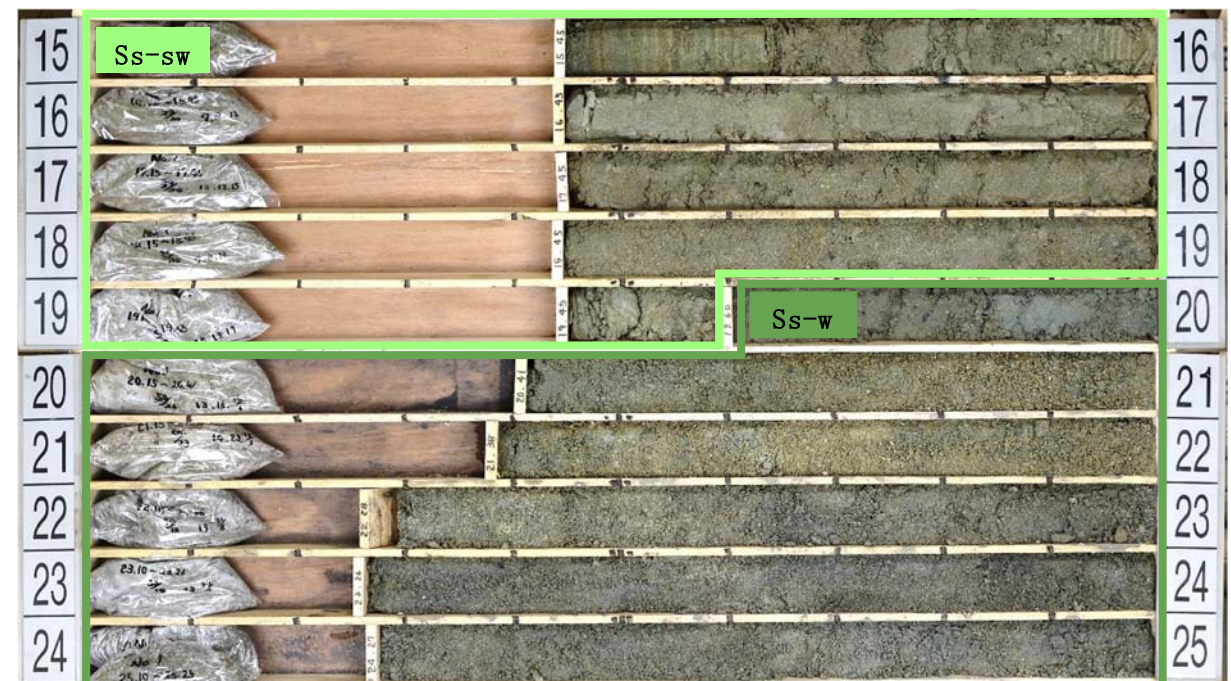
【コア写真（No.1孔：GL-15.00～25.00m）】
